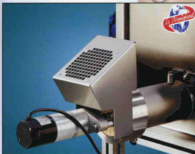
Sistema di ventilazione su trafilatura / Ventilation on die
